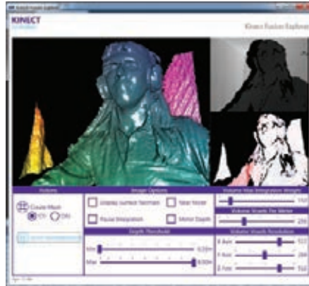
Рис. 3. Вот так Kinect Fusion воссоздает модель, сканируя целевой объект
